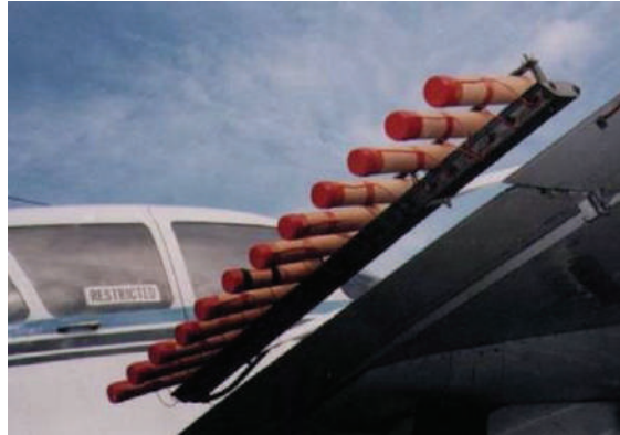
Şekil 1. a. Uçak kanadına takılmış bulut tohumlama fişekleri
