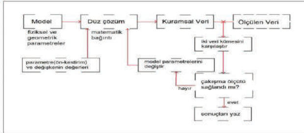
Şekil 6. Ters çözüm işlemi genel akış şeması [Başokur vd., 2004]
